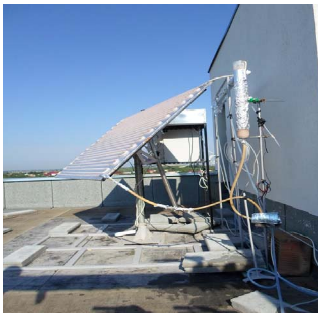
Figurile 8 și 9. Instalație pilot fotocatalitică solară
