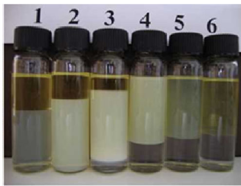
Fig. 5. Comportarea de fază a sistemelor motorină-ulei de rapiță/apă (NaCl)/AOT-Brij 30 în funcție de concentrația de electrolit din apă. În flacoanele 1-6 concentrația de NaCl a fost: 0,25%, 0,4%, 0,5%, 0,6%, 0,7% și 0,8%.
