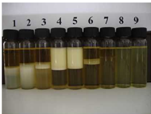
Fig. 4. Comportarea de fază a sistemului motorină/apă/amfifil [AOT-Brij 30- i -butanol (1:1:1)] în funcție de concentrația amfifilului. Concentrația de amfifil în flacoanele 1-9 a fost de: 2%, 4%, 5%, 6%, 7%, 10%, 15%, 18% și 20%.
