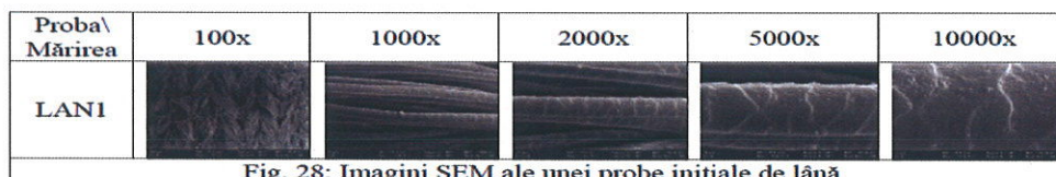
Fig. 28: Imagini SEM ale unei probe inițiale de lână
